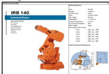
Gambar 19. Spesifikasi Robot ABB IRB 140
