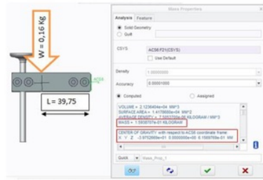
Gambar 13. Analisis Berat dan Titik Berat Lengan Gripper
