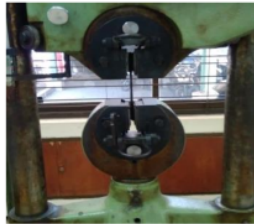
Gambar 3. Pengujian tarik komposit
