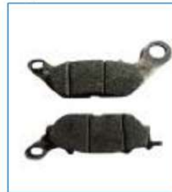
Gambar 11. Foto brake pad material komposit C3 serbuk aluminium, serbuk tempurung kelapa, serbuk karbon aktif.
