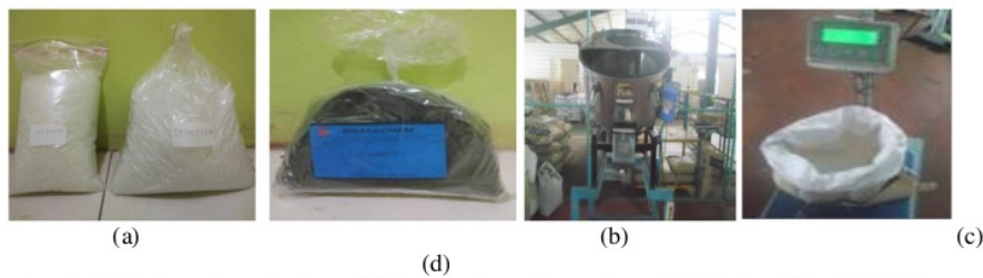
Gambar 4. (a) Polyurethane isothane (b) Polyurethane desmophane (c) Mesin mixing (d) Timbangan
