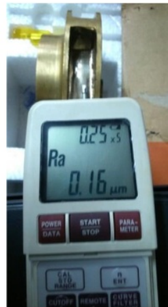
Gambar 2 Pengukuran Kekasaran permukaan sudu impeller
