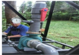
Gambar 4 Pengukuran tekanan pada saluran masuk PAT
