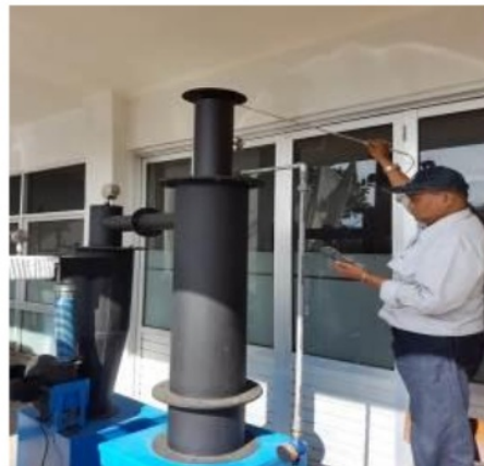
Gambar 4.7 Pengukuran Kecepatan udara
