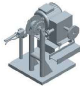
Gambar 8. Desain terpilih alat uji pengereman
