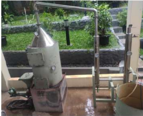
Gambar 4. Insinerator pirolisis tipe batch yang digunakan
