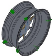
Gambar 6. Meshing Pelek Tipe 2
