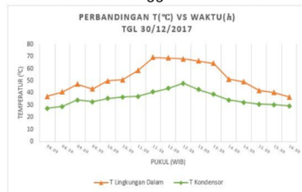
Gambar 4.2 Grafik Perbandingan Temperatur Lingkungan Dalam dan Temperatur Kondensor Tanggal 30 Desember 2017
