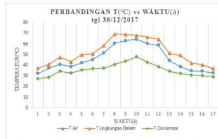
Gambar 4.1 Grafik Distribusi Temperatur Alat Desalinasi Pada Tanggal 30 Desember 2017
