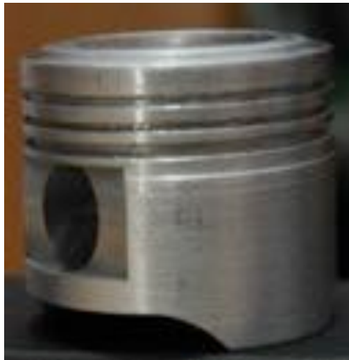
Gambar 27. Piston hasil pembuatan dengan proses squeeze casting dan pemesinan.
